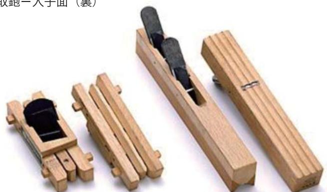
▲ 左より：面取鉋一組子面、面取鉋一組子面（裏）、面取鉋一二丁掘変形面、面取鉋一変形面（裏）
