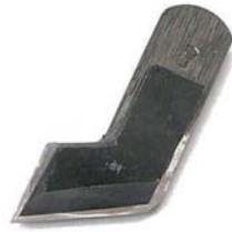
台の上端左が欠き取られているので、材の欠き取られた部分の際削りと、角脇削りができる。
