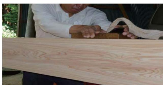
平鉋のうち、刃幅が3寸以上のものを大鉋、1寸8分以下で台も短いものを小鉋、8分以下で台も極めて小さいものを豆鉋と呼びます。平鉋以外の鉋も、それぞれの種類の中で小型のものを小鉋、極めて小さいものを豆鉋と呼びます。また、通常の刃幅で、台が40cm前後のものを長台鉋、35cm前後のものを中台鉋と呼びます。
