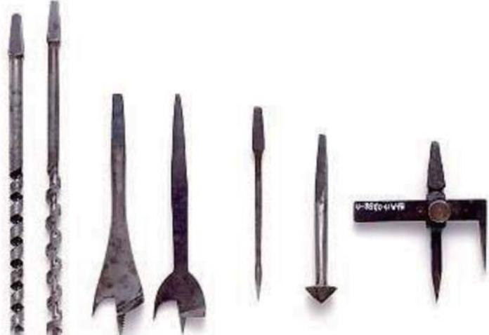
▲ ハンドル錐先 左より ネジ錐一小林式、ネジ錐一アメリカ式、板錐、三ツ目錐、菊座錐、自在錐
