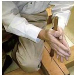
わが国では伝統的に釘穴をあける時などに手揉み錐を用いてきましたが、明治に入り洋風建築とあわせてボルトを用いた接合法が導入されると、ネジの形をしたボルト錐が使われるようになり、これによって太くて深い穴があけられるようになりました。
