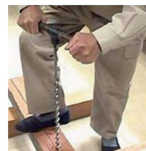
揉み錐は往復回転運動させながら孔をあける道具ですが、反対に連続して回転を与えて孔をあける道具がボルト錐、クリコ錐です。
