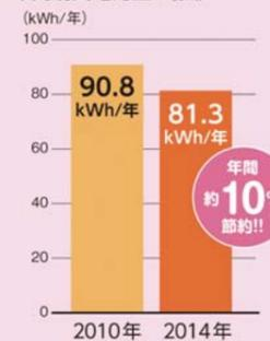
ジャー炊飯器の年間消費電力量は、炊飯時、保温時、タイマー予約時及び待機時それぞれの消費電力を測定し、家庭における最大炊飯容量ごとの使用頻率をもとに算出して合計した値を、有効数字3桁以上で表示しています。
